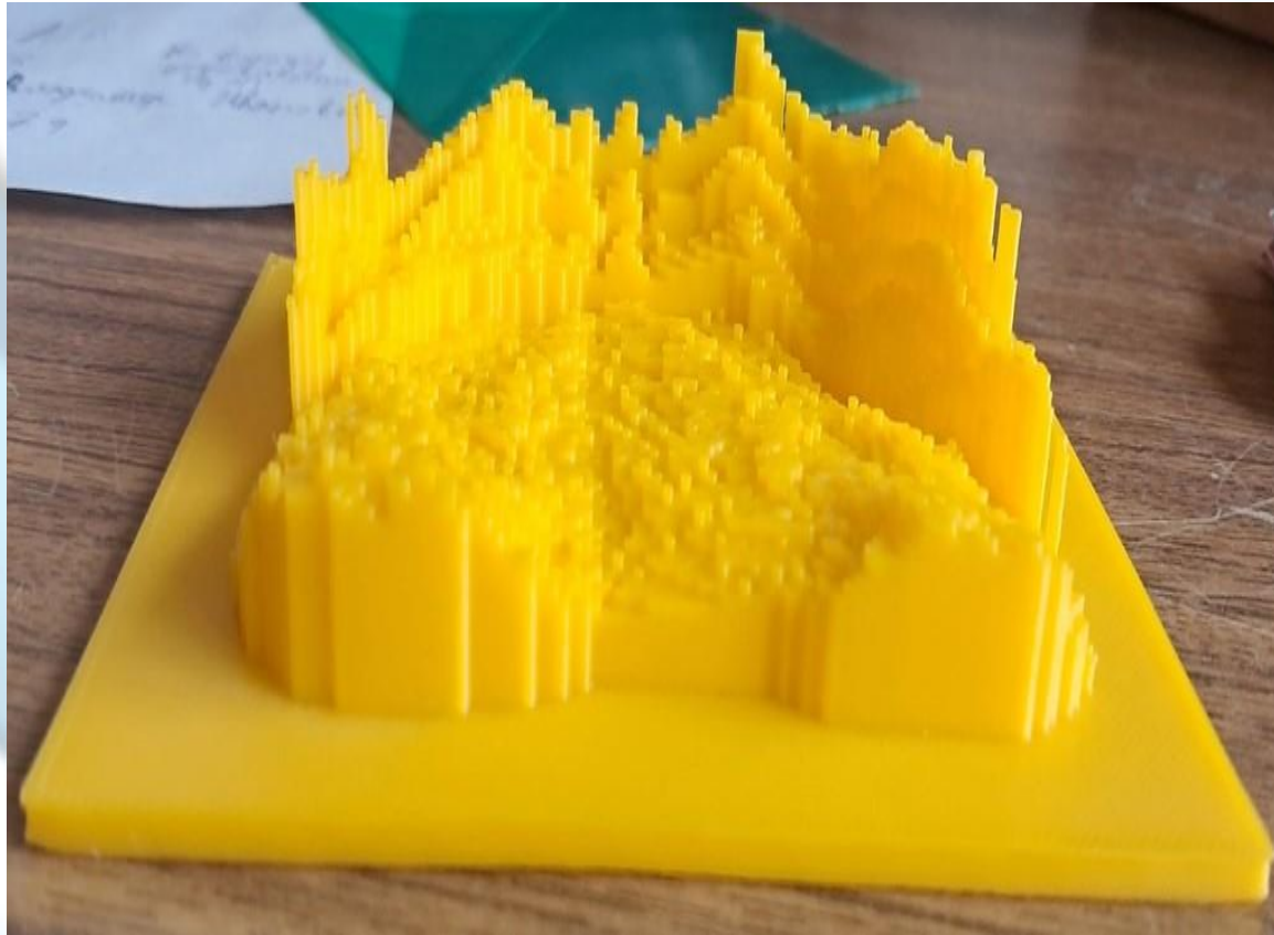
Рис. 4 Напечатанный болюс на 3D-принтере из PLA пластика
