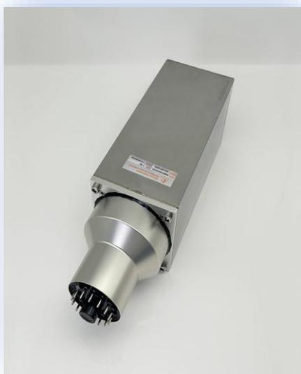
Фотоэлектронный умножитель (ФЭУ) - это элемент, используемый в сцинтилляционных детекторах для обнаружения и измерения ионизирующего излучения. ФЭУ состоят из фотокатода, массива динодов и анода. Когда фотон попадает на фотокатод, он высвобождает электроны за счет фотоэлектрического эффекта. Затем эти электроны ускоряются и многократно увеличиваются в количестве, проходя через ряд динодов. Электроны достигают анода, генерируя электрический импульс.
