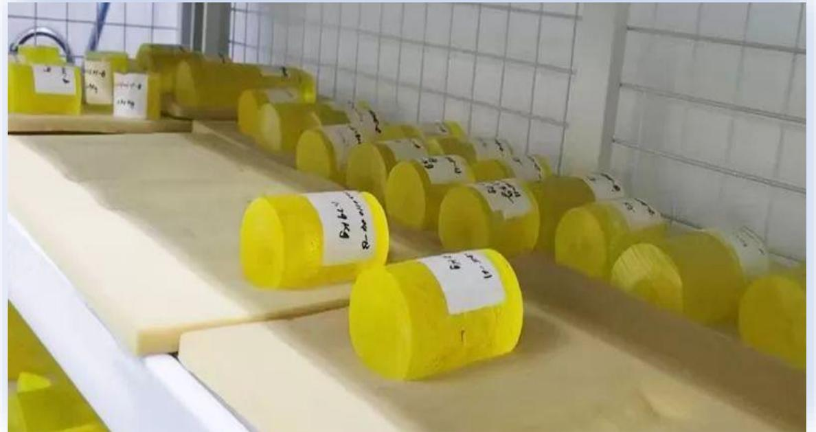
Сцинтиллятор GAGG(Ce) была запущен в 2016 году и в настоящее время серийно производится були диаметром 60 мм х длиной 200 мм со стабильной однородностью световыхода.
