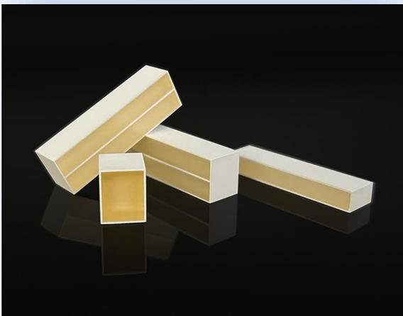
Кристалл CdWO<sub>4</sub> относится к сцинтилляционным кристаллам, изготовленным из вольфрамата кадмия (CdWO<sub>4</sub>). Это широко используемый неорганический сцинтилляционный материал, известный своей высокой плотностью и хорошими свойствами обнаружения излучения. Кристалл состоит из атомов кадмия, вольфрама и кислорода.
