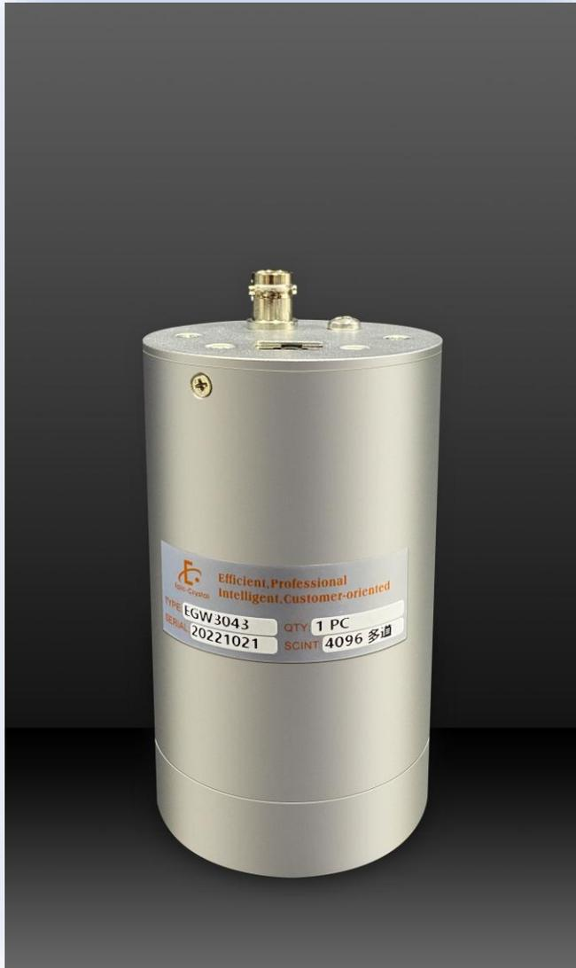
Многоканальный анализатор EGW3043 Tube Base - это анализатор высоты импульсов на ламповой основе, включающий в себя 14-контактный фотоумножитель, встроенный MCA анализатор с разрешением 4096 каналов и согласующие усилители, высоковольтные источники питания и т.д., которые могут работать в режиме одноканального анализатора (SCA) или режиме многоканального анализатора высоты импульсов
