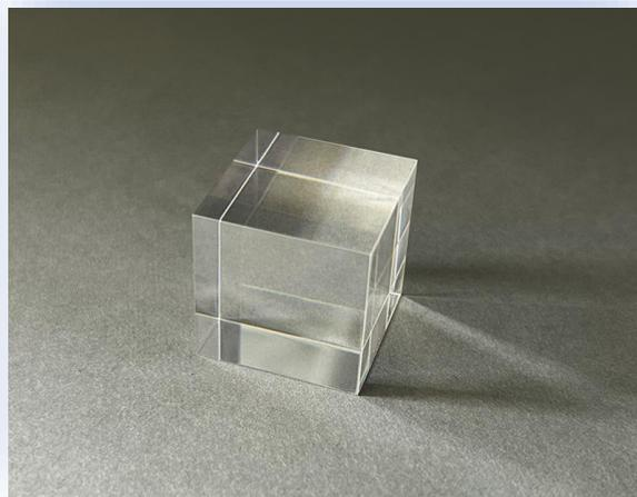
Кристалл YSO(Ce), легированный церием, YSO(Ce), относится к моноклинным редкоземельным ортосиликатным кристаллам, он аналогичен кристаллу LYSO(Ce), хотя обычно используется в качестве полупроводника и в фотооптических приложениях. Кристалл YSO(Ce) имеет тот же пик излучения 420 нм, что и кристалл LYSO(Ce), но он менее эффективен с точки зрения светоотдачи, которая составляет около 18 000 фотонов/МэВ, время затухания у кристалла YSO(Ce) на 50-70 нс медленнее, чем у кристалла LYSO(Ce) на 40 нс.
