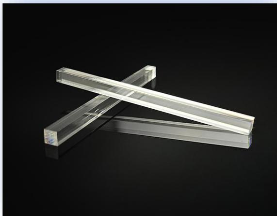
Сцинтилляционный кристалл YAP(Ce) обладает быстрым временем затухания (28 нс) и относительно высокой светоотдачей (40% от NaI (TI)), пик излучения составляет 360-380 нм, что может быть эффективно согласовано с большинством современных фотоприемников. YAP(Ce) может подвергаться точной механической обработке, использоваться для подсчета гамма и рентгеновских лучей, электронной микроскопии, электронных и рентгеновских томографических экранов.
