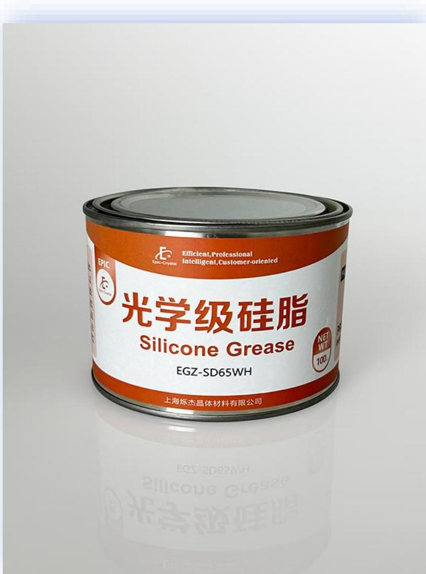
EGZ-SD65WH - это прозрачная бесцветная силиконовая оптическая соединительная смесь, которая обладает отличным светопропусканием и низким уровнем испарения при температуре 25 °С, а также удельным весом 1,12 и показателем преломления 1,467. EGZ-SD65WH предназначен для оптического соединения фотодатчиков со сцинтилляторами и световодами, например, для соединения фотоумножителей.
