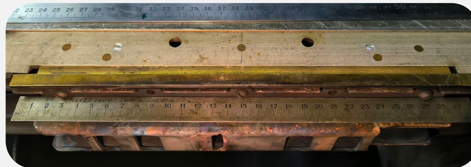
ЩЕЛЕВАЯ ДИАФРАГМА НА ЛЕВОМ ДУАНТЕ
