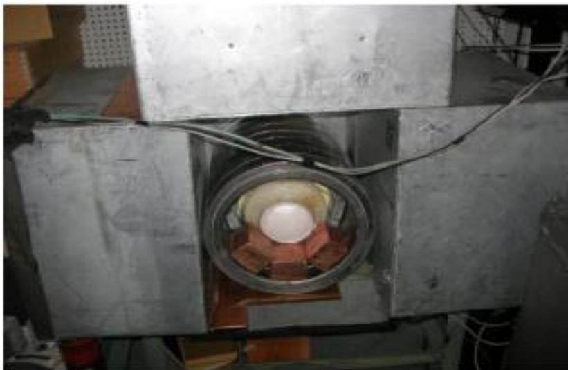
*Si(Li) и HPGe детекторы и  $^{57}\text{Fe}$  и  $^7\text{Li}$  мишени помещались внутри низкофоновой установки на поверхности Земли, снабженной активной защитой от мюонов и ядерно-активной компоненты космического излучения. Наиболее строгие, на тот момент, ограничения на массу  $^7\text{Li}$ - и  $^{57}\text{Fe}$ -аксионов.*
