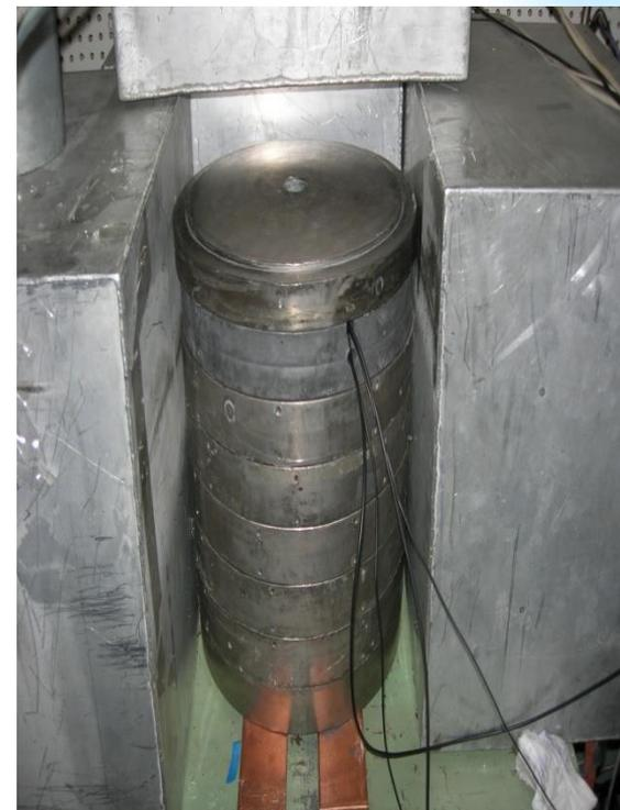
Ожидаемый поток солнечных аксионов может быть выражен в терминах потоков  $7Be$ - и  $pp$ -нейтрино. Потоки зависят от  $g_{AN}$ . Мы предложили искать а.э. эффект на атомах  $Bi$ , используя кристаллы  $BGO$ . Пассивная защита детектора состояла из слоев  $Pb$ ,  $Bi$  и  $Cu$ . Активное вето состоящее из 5 пл. сцинтилляторов размером. В *Borexino* выбраны три новых реакции для обнаружения аксионов.
