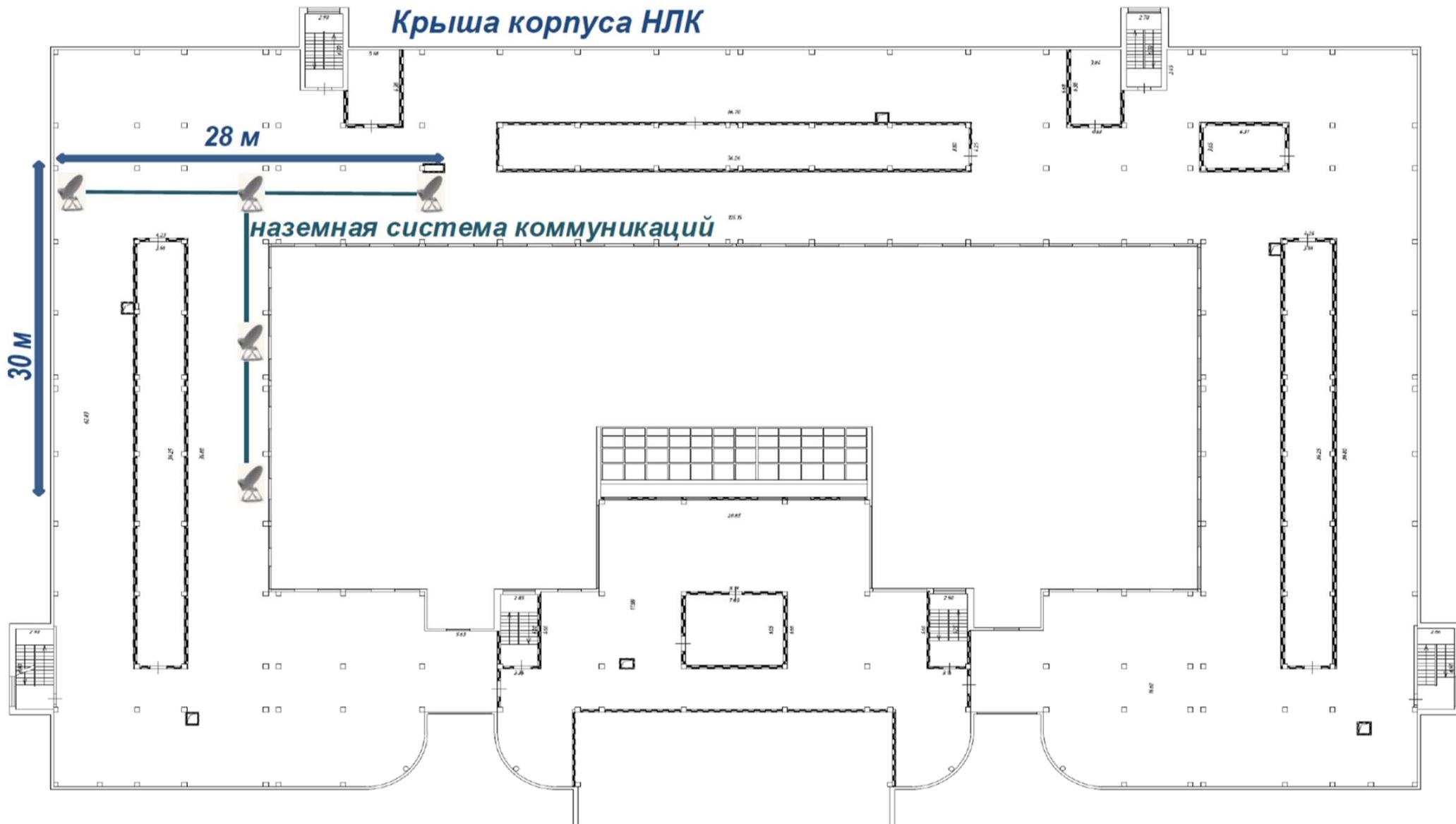
**Примерная схема монтажа II ветки прототипа радиоинтерферометра МИФИst на крыше корпуса НЛК (5 антенных модулей, размеры  $D=28 \times 30$  м, угл. разрешение  $\sim 0,40^\circ$  на частоте 1,42 ГГц линии НI 21.1 см и  $0.09^\circ$  на частоте 6.5 ГГц. Max размер одного плеча может быть 61 м, что обеспечит угловое разрешение  $0,04^\circ$  на частоте 6.5 ГГц.**
