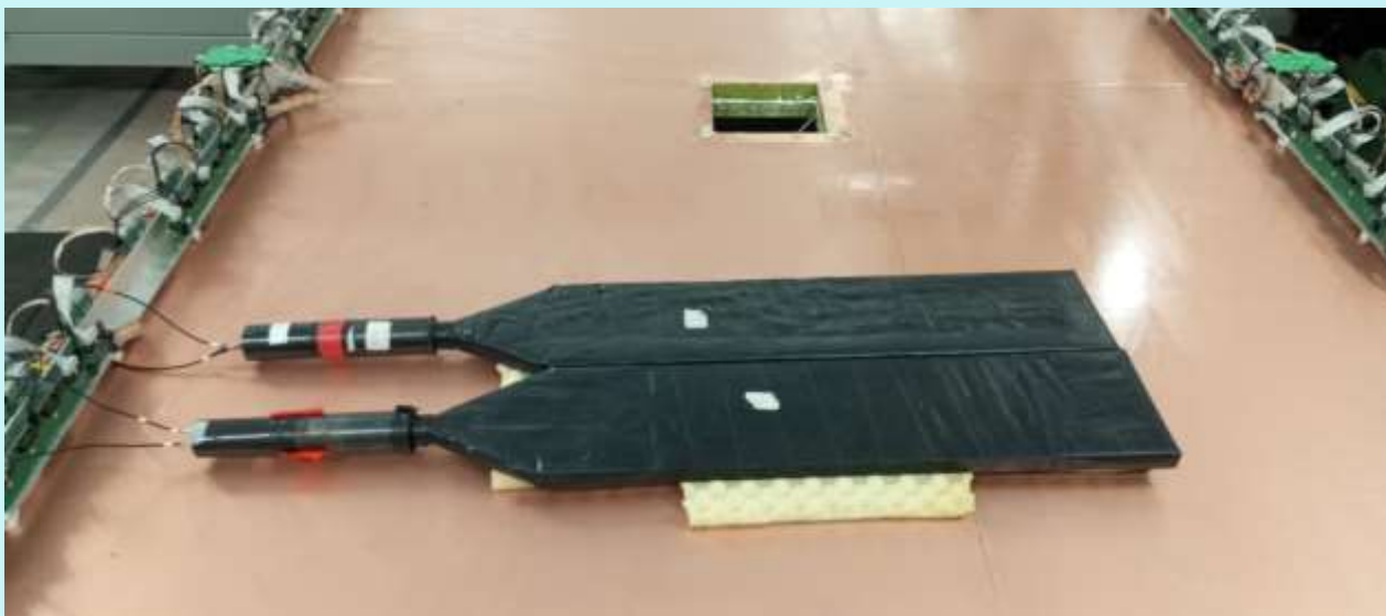
Схема стендовых испытаний CSC на космических мюонах
