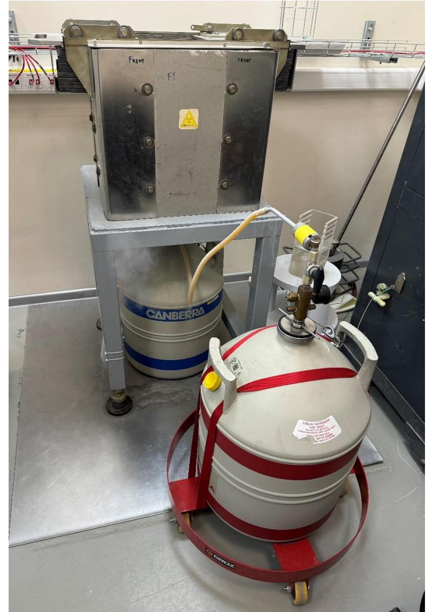
Рис. 9. Внешний вид спектрометра CANBERRA GC3018
